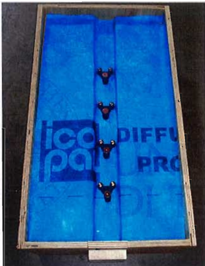
Figura 2 – Vista di un campione prima del getto del calcestruzzo (1H 150A).
