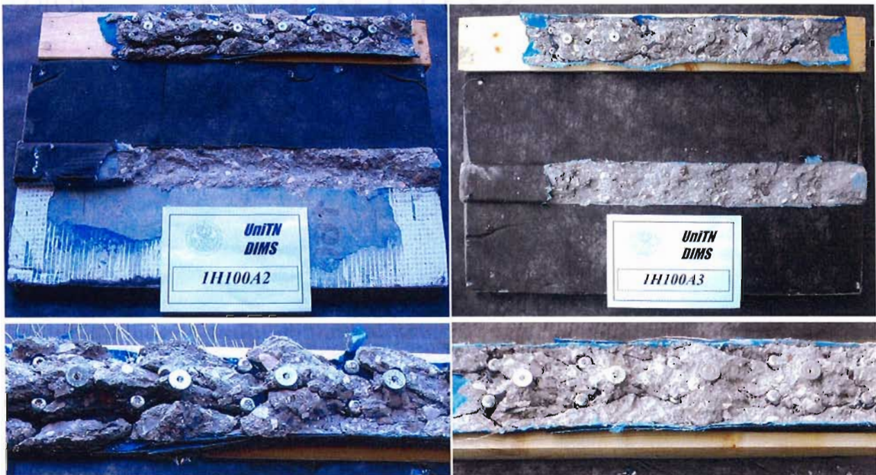
Figura 8 - Modalità di rottura di provini tipo 1H 100A.
