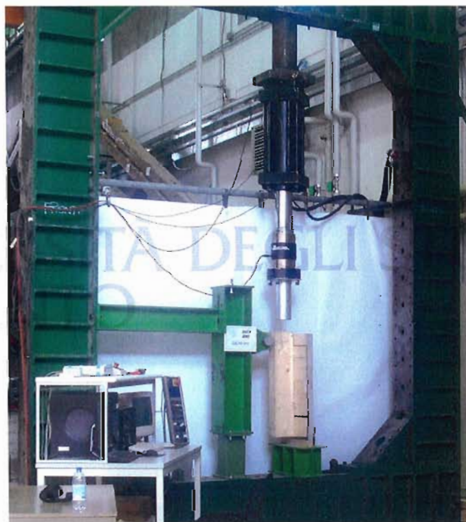
Figura 6 – Telaio di contrasto, attuatore MTS e postazione di controllo/acquisizione.
