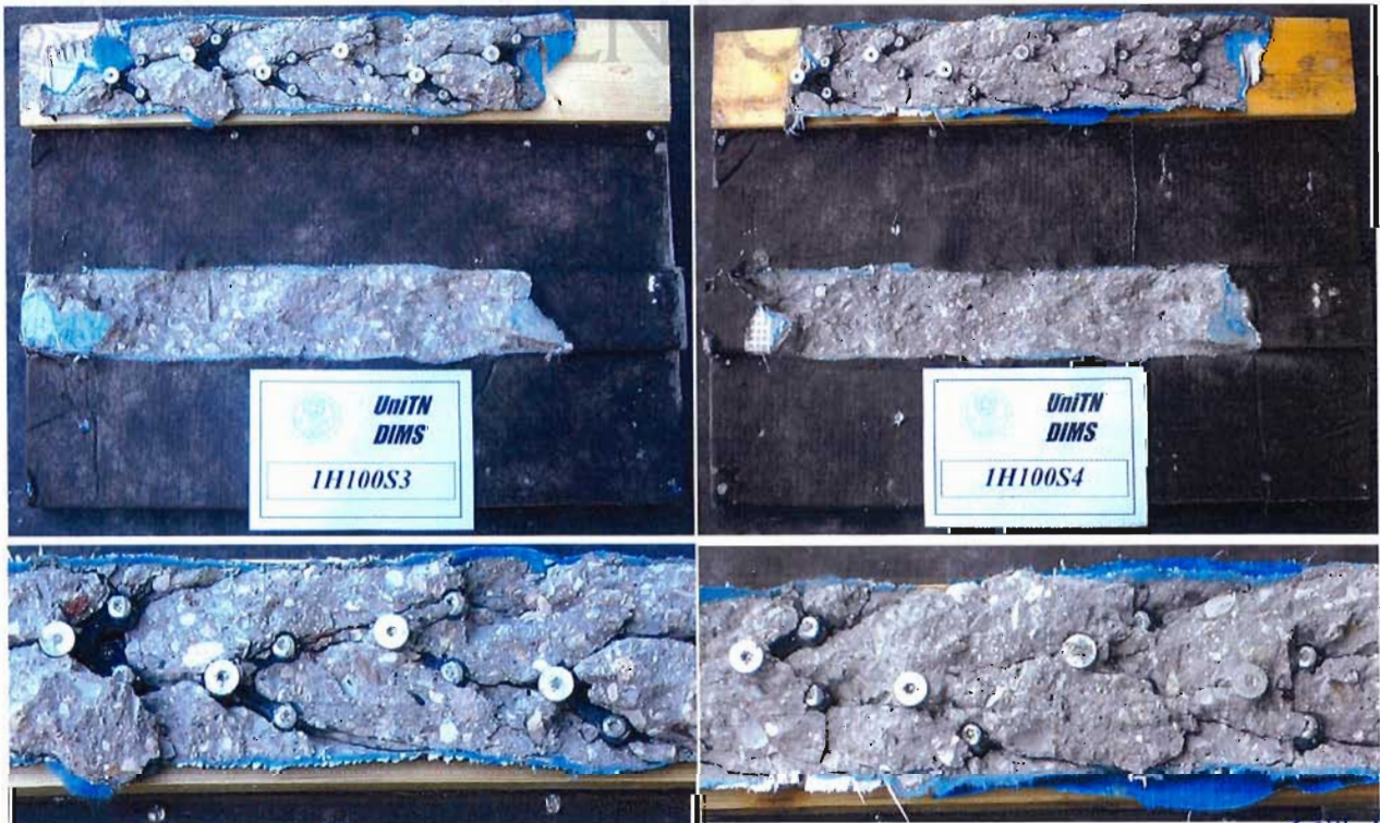
Figura 14 - Modalità di rottura di provini tipo 1-H-100S.
